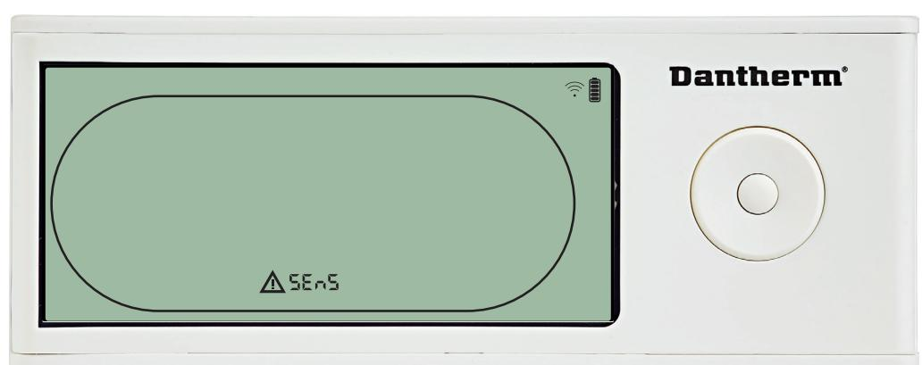
Affugteren stoppes, fordi der er detekteret en sensorfejl. Sensorfejl kan ikke tilsidesættes fra DRC1. Brug OP- eller NED-knappen til at få vist, hvilken sensor/hvilke sensorer der er defekt. Hvis alle sensorerne er defekte, vises disse koder i følgende rækkefølge: "COnD" ↑↑"EVAP" ↑↑"rh°" Det er ikke muligt at åbne menuopsætningen for at ændre sætpunktværdierne.
